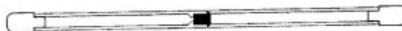
Figura: Coletor de mercúrio em forma de cartucho preenchido com material adsorvente (em preto)
