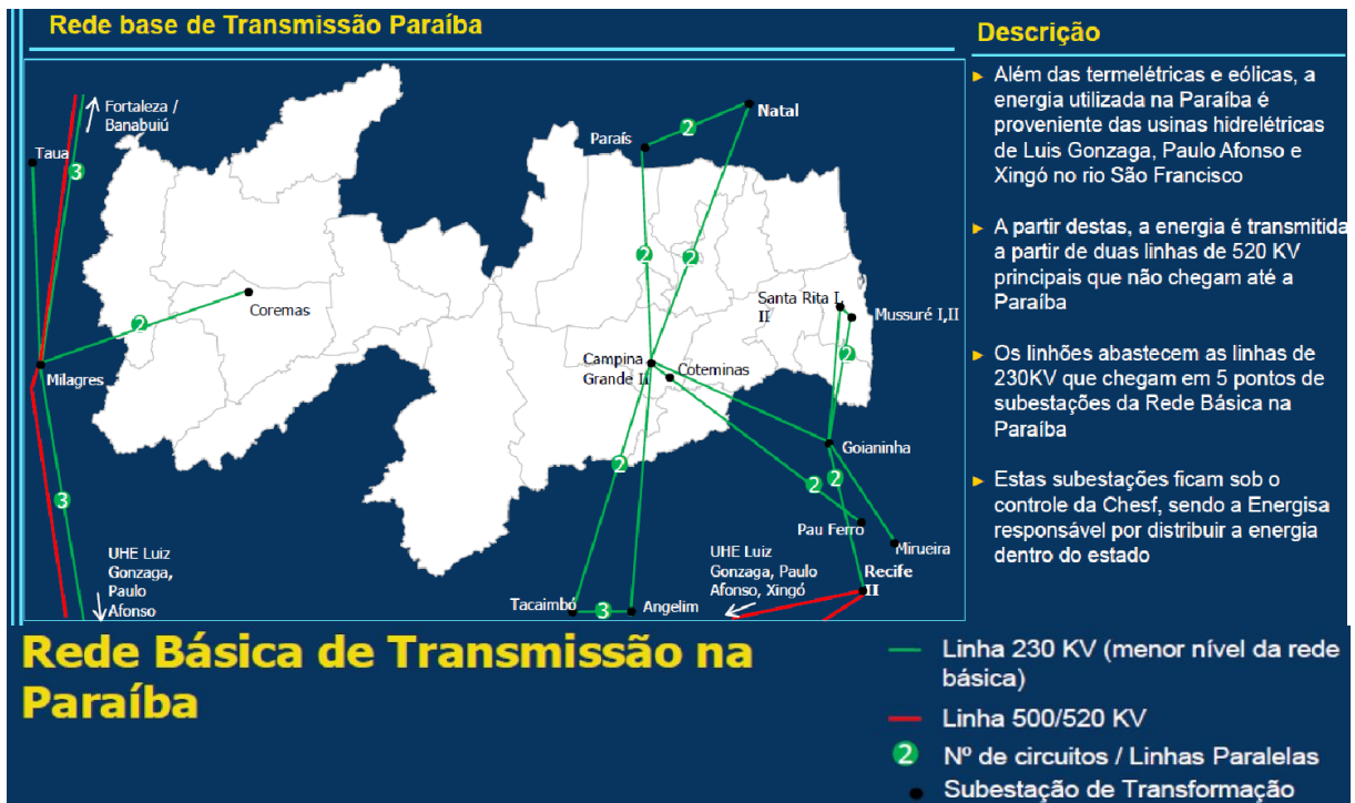
Figura 4. Redes de transmissão de energia oriunda das hidrelétricas do rio São Francisco ao estado da Paraíba. Fonte: SEPLAG, 2014.
